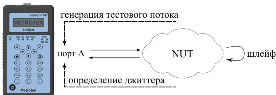
Рисунок 7.2. Схема генерации тестового потока и измерения джиттера с использованием шлейфа
