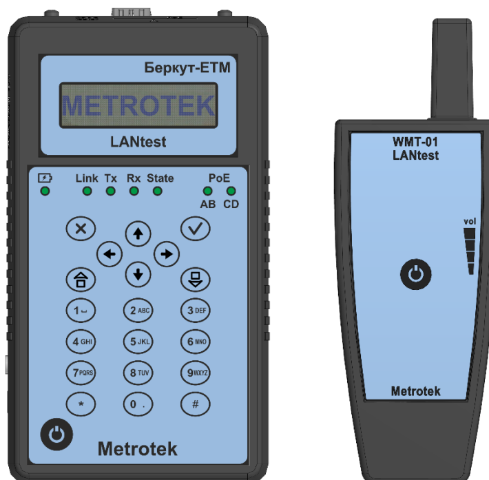
Рисунок 1.1. Внешний вид прибора Беркут-ЕТМ и тестового щупа WMT-01
